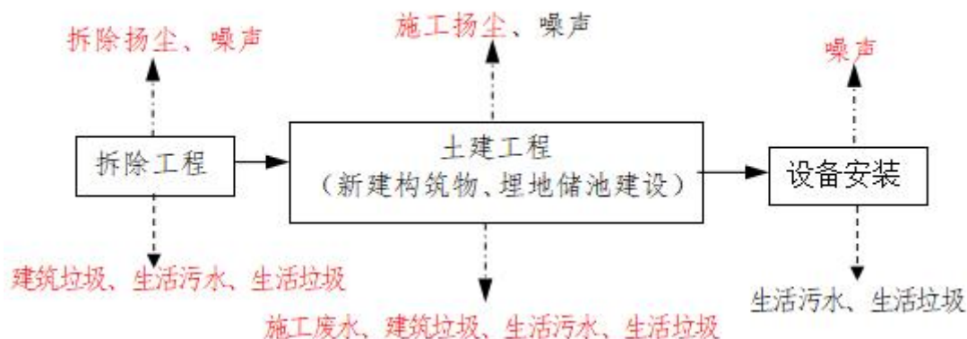
图 2-3 施工期工艺流程及产污节点图
